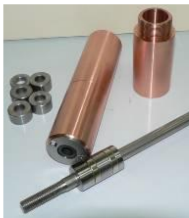
Obrázek 4 - Fotografie testovacího vzorku EM tlumiče [9]
