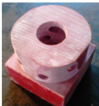
Obrázek 17 - Vedení pro zajištění kmitání v jedné ose
