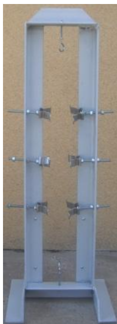
Obrázek 18 - Zhotovená rámová konstrukce
