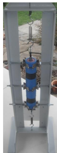
Obrázek 19 - Reálná soustava s elektromagnetickým tlumičem
