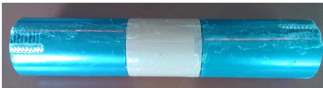
Obrázek 10 - Zkonstruovaný stator [1]
