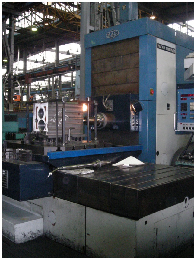
Obr.4.1 Stroj WHX 100 NC při vyvtávání děr
