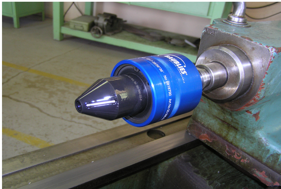
Obr. 4.5 Válečkovací nástroj Baublies IRG-K-3 upnutý v pinole koníku.
