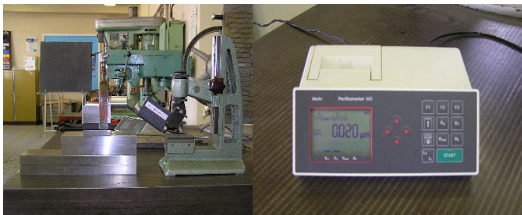
Obr. 4.7 Profilometr Mahr Perthometer M2
