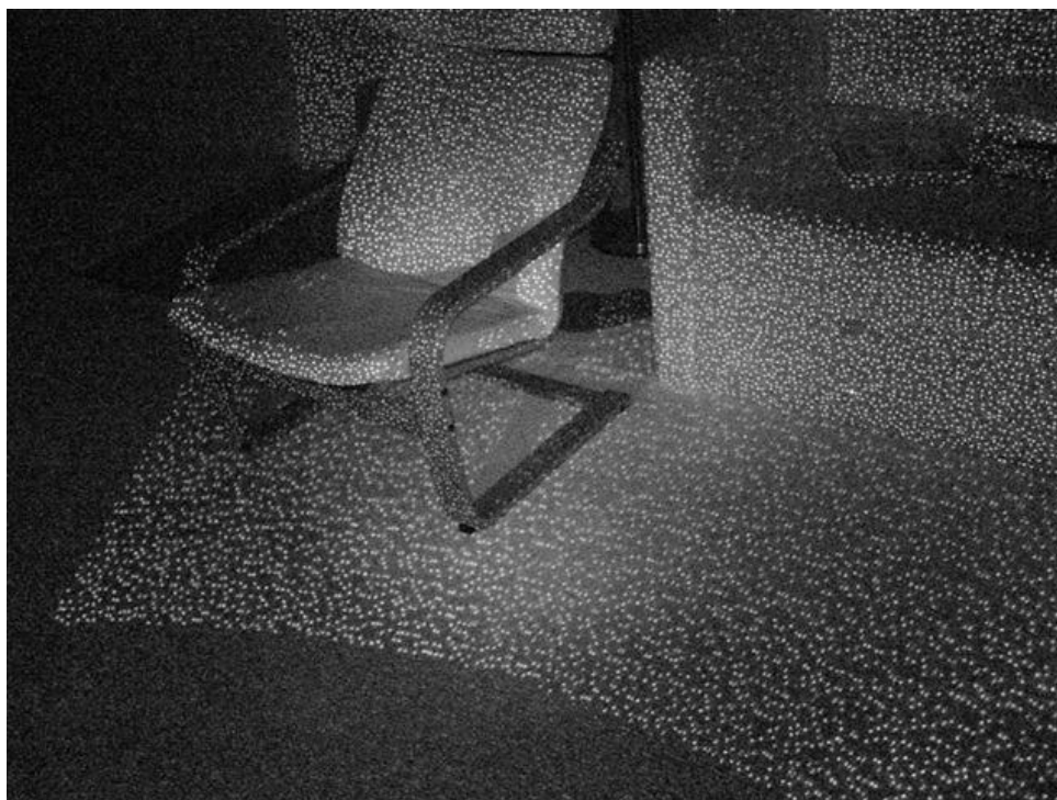
Obrázek 3 – Ukázka IR projekční matice senzoru Kinect [14]
