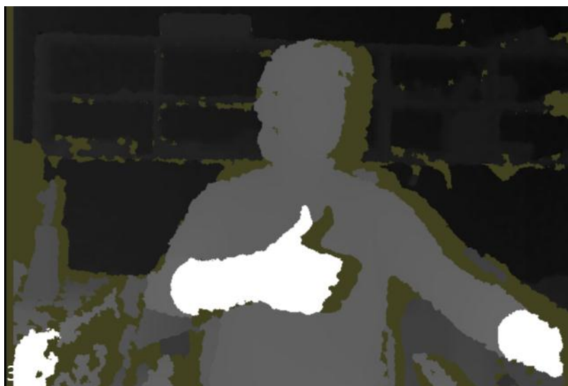
Obrázek 4 - Ukázka hloubkové mapy. Světlejší odstín odpovídá kratší vzdálenosti, zelenohnědé plochy jsou místa, kde nelze vzdálenost přesně určit (například je dané místo zastíněno jiným objektem).
