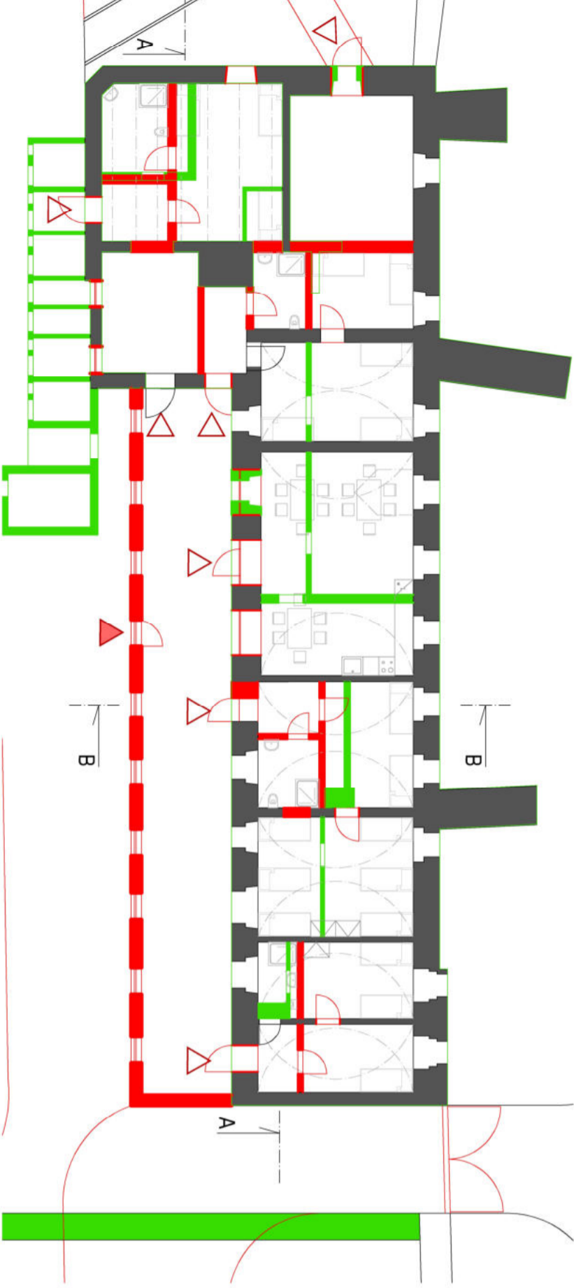
SCHEMA BOURANÝCH KONSTRUKCÍ
