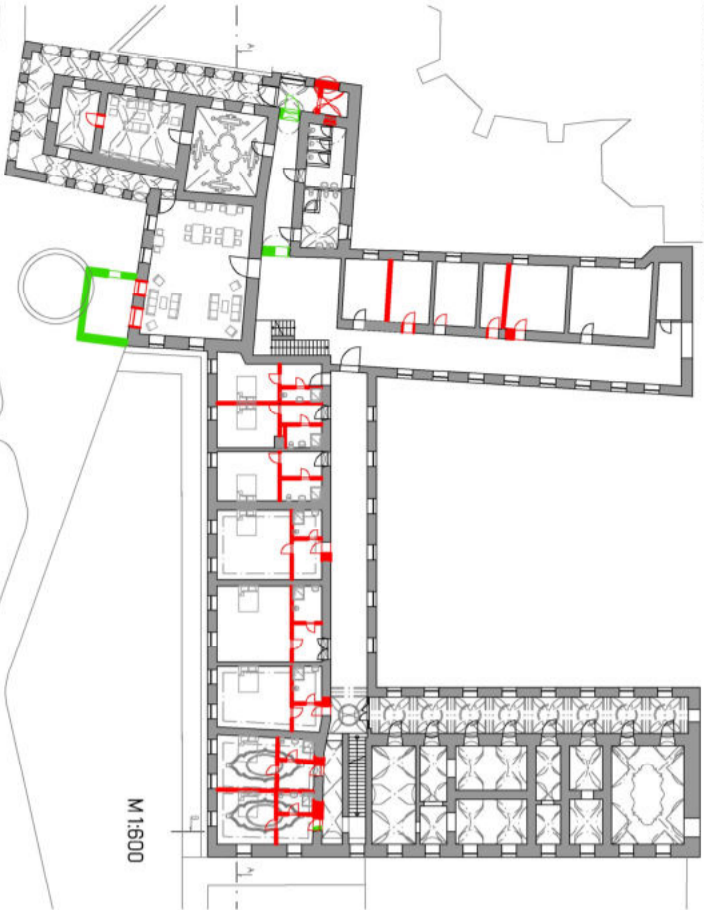
SCHEMA BOURANÝCH KONSTRUKCÍ
