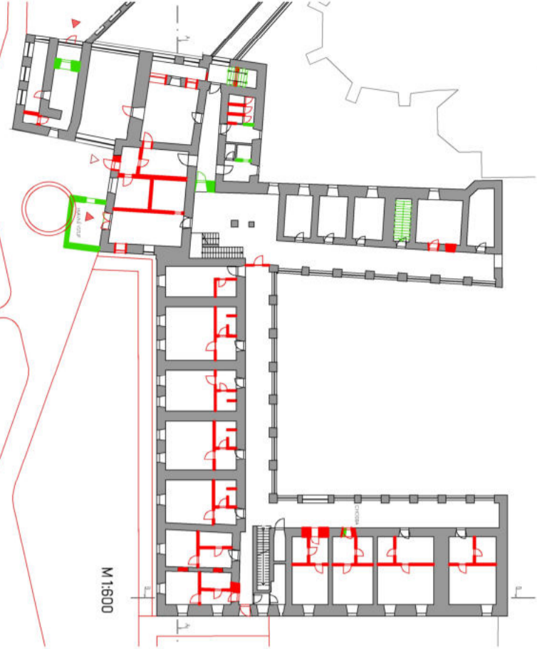
SCHEMA BOUPANÝCH KONSTRUKCI
