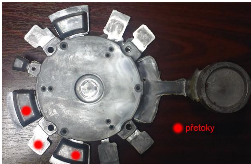
Obr. 2.9 Přetoky na odlitku ložiskového štítu
