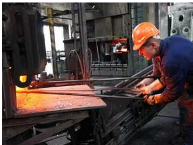
Obr. 6.1 Ruční manipulace s výkovkem [15]
