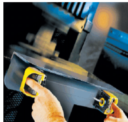
Obr. 5.3 Dvouruční bezpečnostní ovládání Duo Touch [7]
