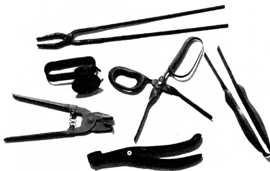
Obr. 6.2 Různé druhy pracovních pomůcek k manipulaci s polotovary a hotovými výlisky [10]
