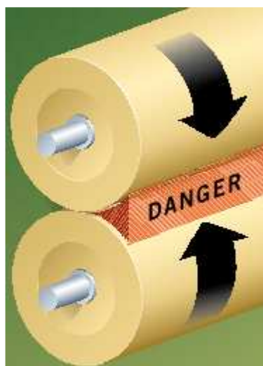
Obr. 4.5 Nebezpečí vtažení prstů v blízkosti pracovních válců [9]
