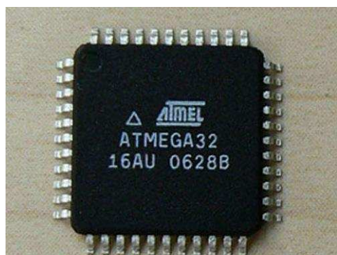
Obrázek 5 Pouzdro TQFP ATmega32 [7]
