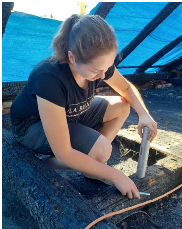
Obrázek 26: Provádění zkoušky pomocí Pilodynu 6J
