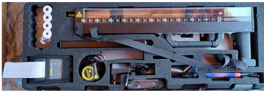
Obrázek 31: Detail přístroje Rinntech Resistograph R650-EA
