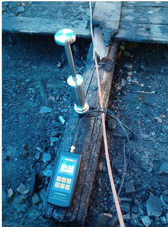
Obrázek 24: Provádění zkoušky pomocí odporového vlhkoměru
