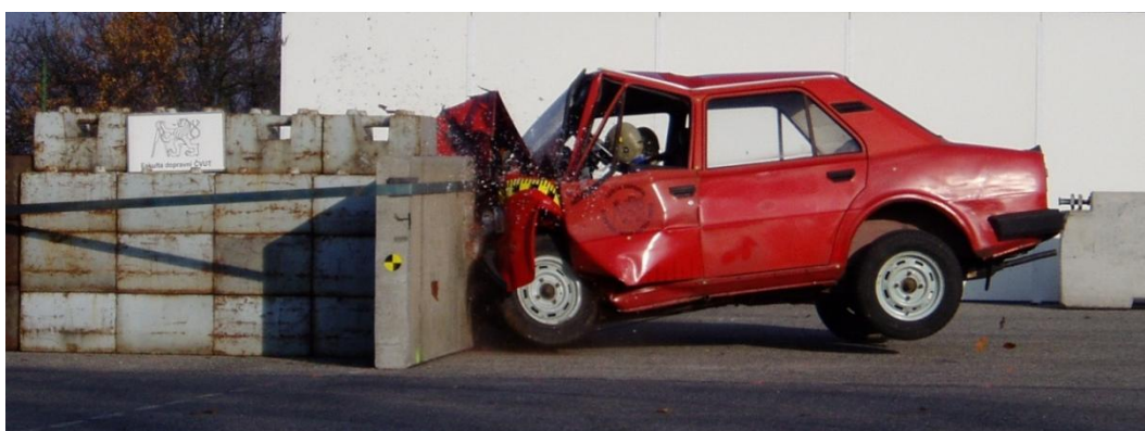
Obrázek 57: Náraz automobilu Š120 do nepohyblivé bariery rychlostí 48km/h s přesazením 30% - maximální deformace [11]
