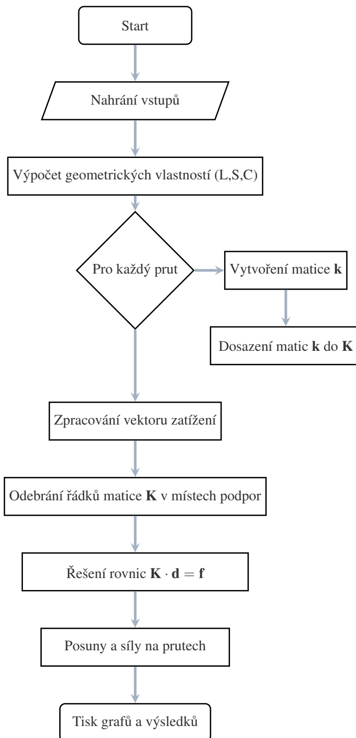
Obrázek 4.2: Průběh lineárního výpočtu v programu HOLFEM.
