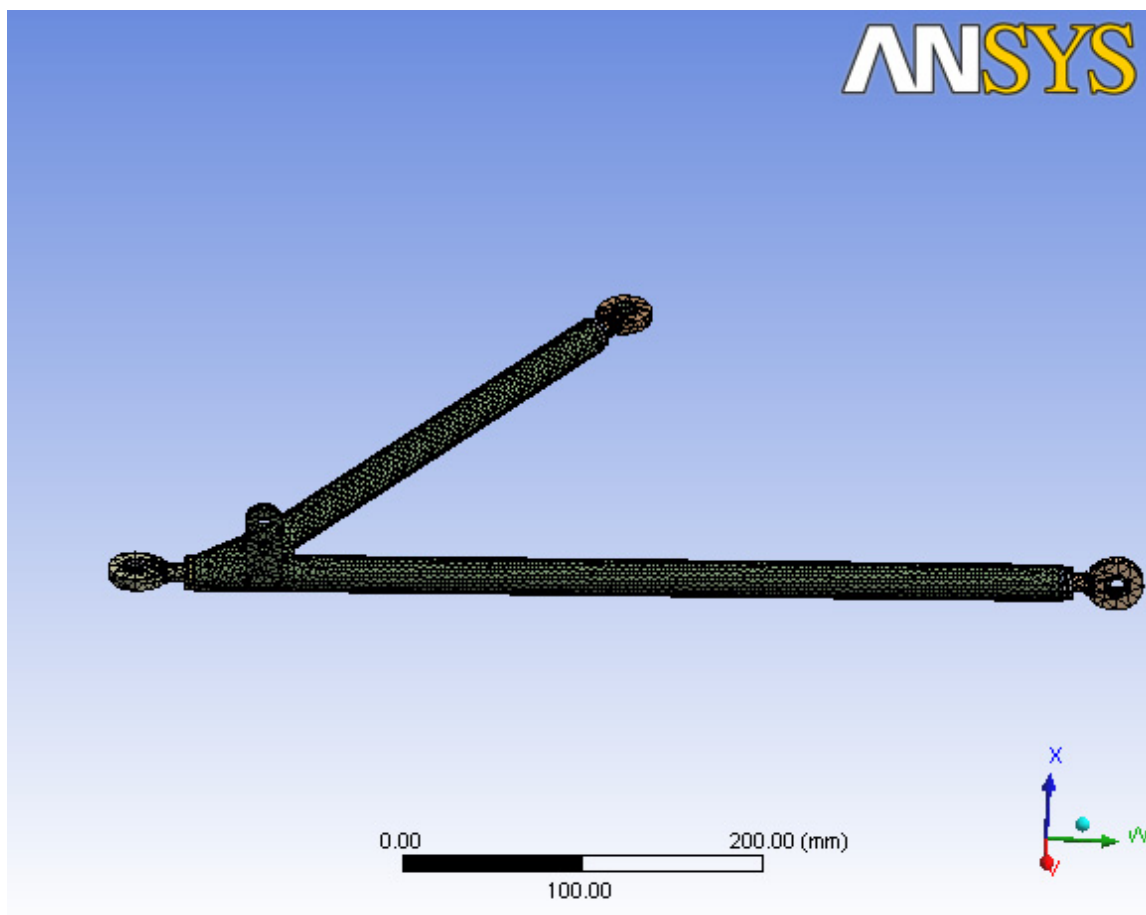
Obr. 62 Ukázka vymeshované součásti elementy
