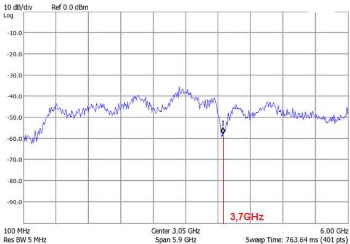
Obrázek 10.13 Využití šumového generátoru - Vivaldi s vloženou měřenou strukturou
