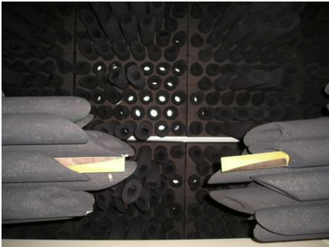
Antény Vivaldi vložené do absorbérů, pro potlačení bočních laloků - detail
