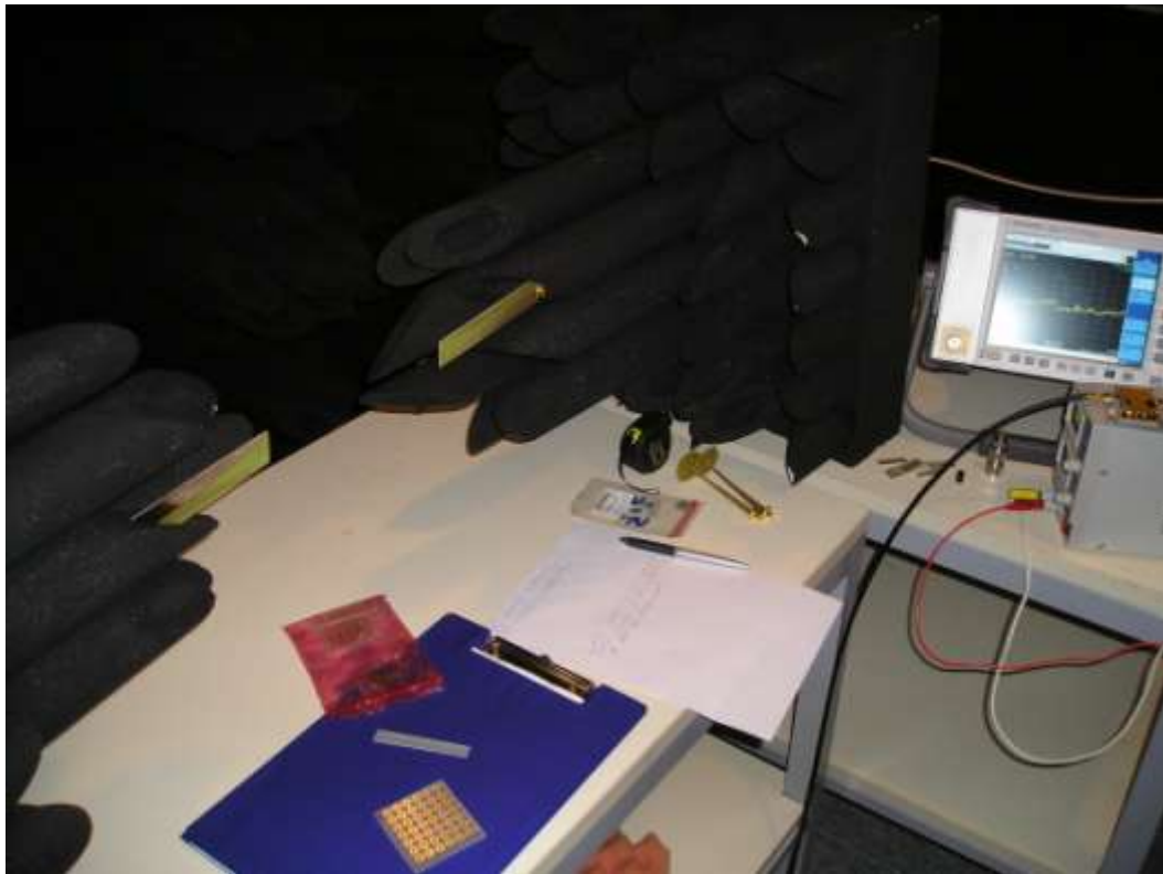
Antény Vivaldi vložené do absorbérů, pro potlačení bočních laloků
