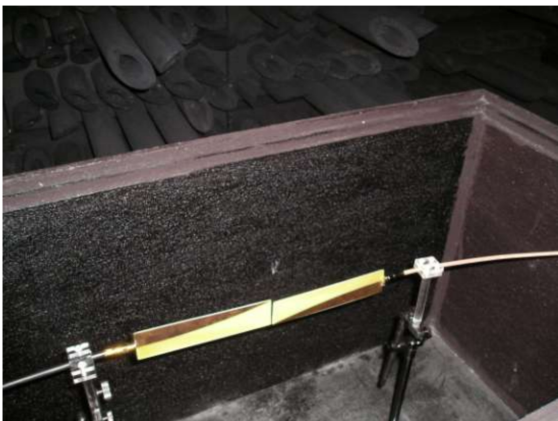
Antény Vivaldi vložené do tlumící krabice - detail
