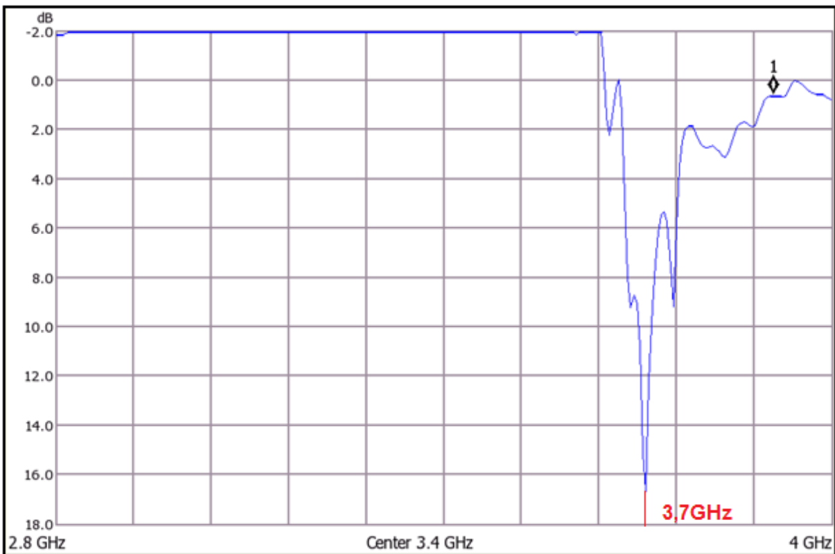
Rezonátorové pole rezonující přibližně na kmitočtu 3,7 Ghz
