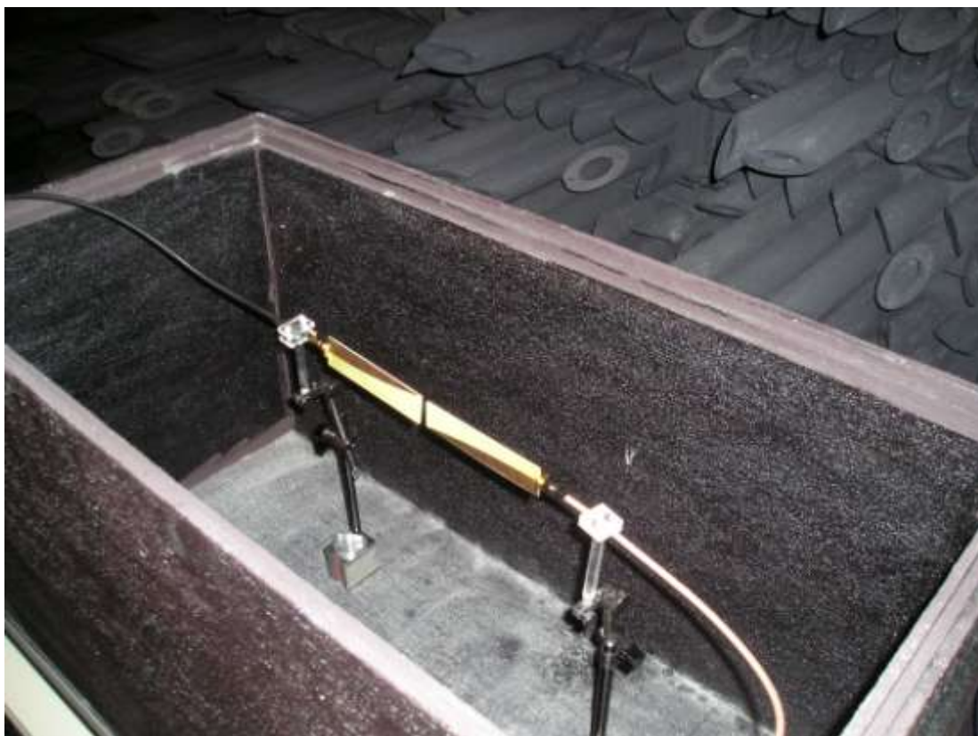
Antény Vivaldi vložené do tlumící krabice
