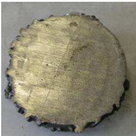
Obr. 27 Průřez odlitku 3/1 bez bublin ( tmavé skvrny jsou způsobeny korozí )
