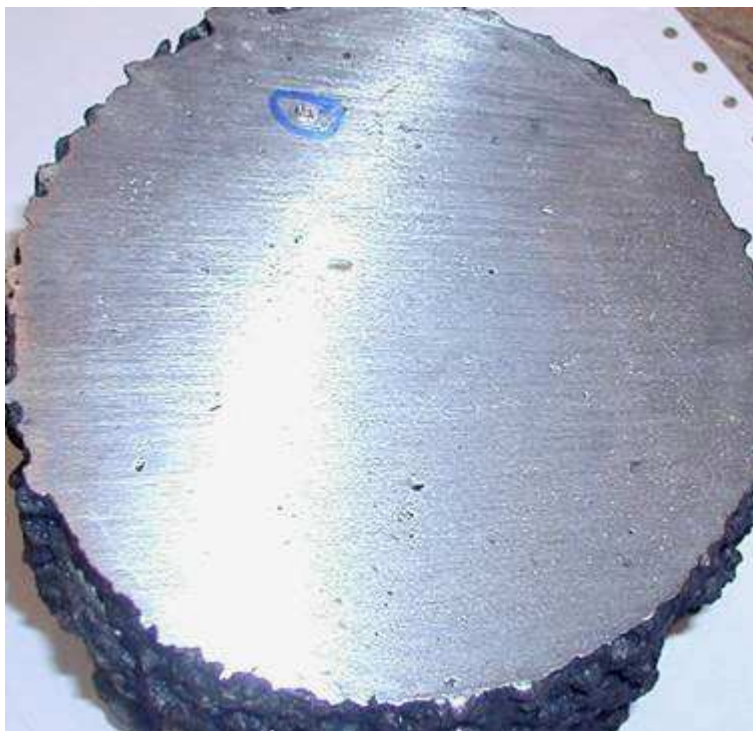
Obr. 12 Drobné bubliny v odlitku 1/2 (vyznačené místo je vyražené číslo odlitku)
