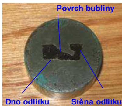
Obr. 4 Bublina u dna odlitku 5/1
