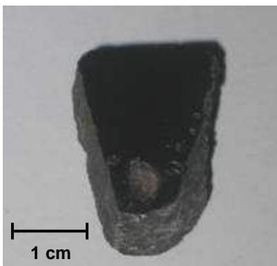
Obr. 42 Bublina v neprůtočném tělísku přilitém pod odlitkem 5/1
