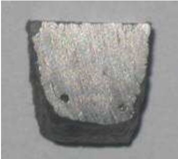
Obr. 46 Drobné bubliny (průměr cca 2 mm) nad dnem neprůtočného tělíska (odlitek 5/2)
