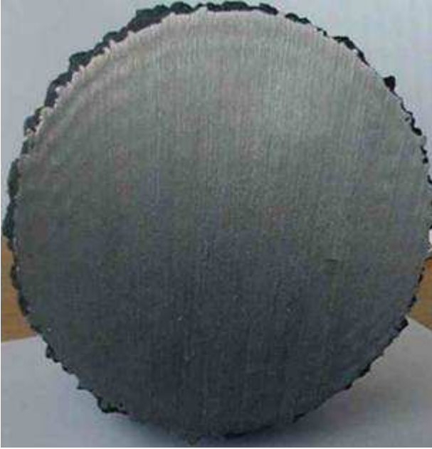
Obr. 15 Průřez odlitku 1/3 – bez bublin
