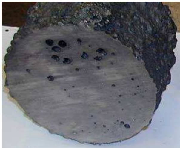
Obr. 9 Bubliny na řezu odlitkem 1/1
