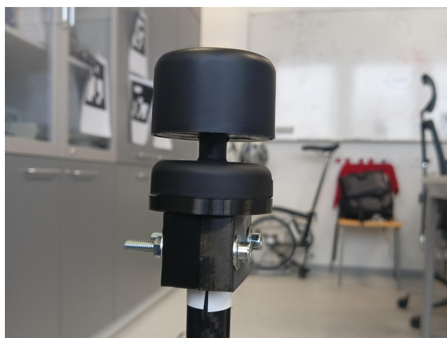
Obr. B.2: Detail uchycení anemometru ke karbonové tyči
