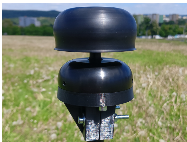
Obr. B.4: Detail uchycení anemometru ke karbonové tyči
