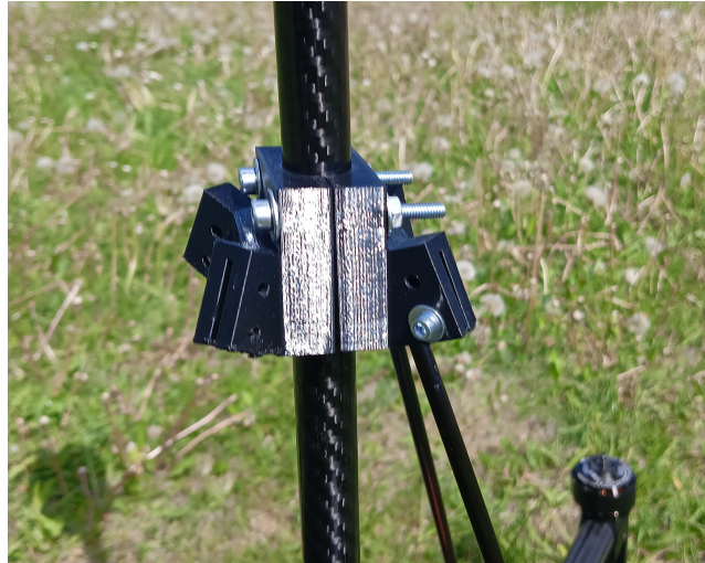
Obr. B.5: Detail uchycení podpěr
