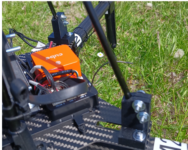
Obr. B.6: Detail uchycení podpěr
