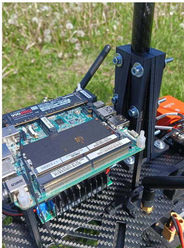
Obr. B.3: Detail uchycení karbonové tyče k dronu
