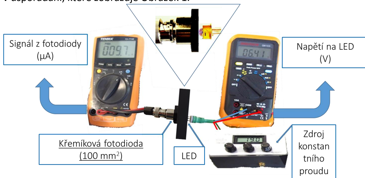
Obrázek 1: Uspořádání měřícího systému pro měření zářivého a elektrického výkonu.
