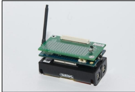
Obrázek 13 - Uzel IRIS XM2110 s připojenou sensorovou deskou MDA100CB
