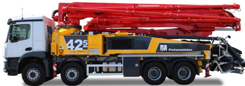
Obr. 37 - Čerpadlo betonu Putzmeister M42 [25]
