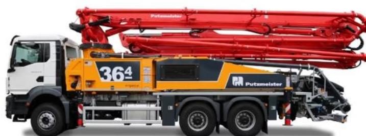
Obr. 40 - Čerpadlo betonu Putzmeister M36 [25]
