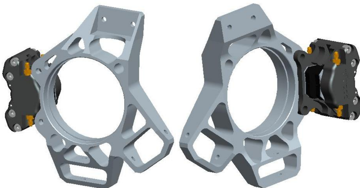
Obr. 43 Přední těhlice s brzdovým třmenem – konečná varianta
