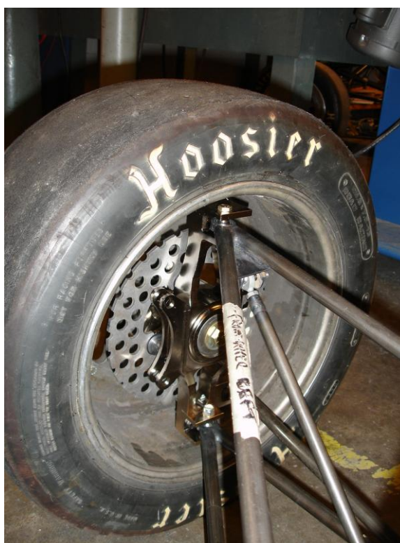
Obr. 11 Přední těhlice univerzity Colorado [6]
