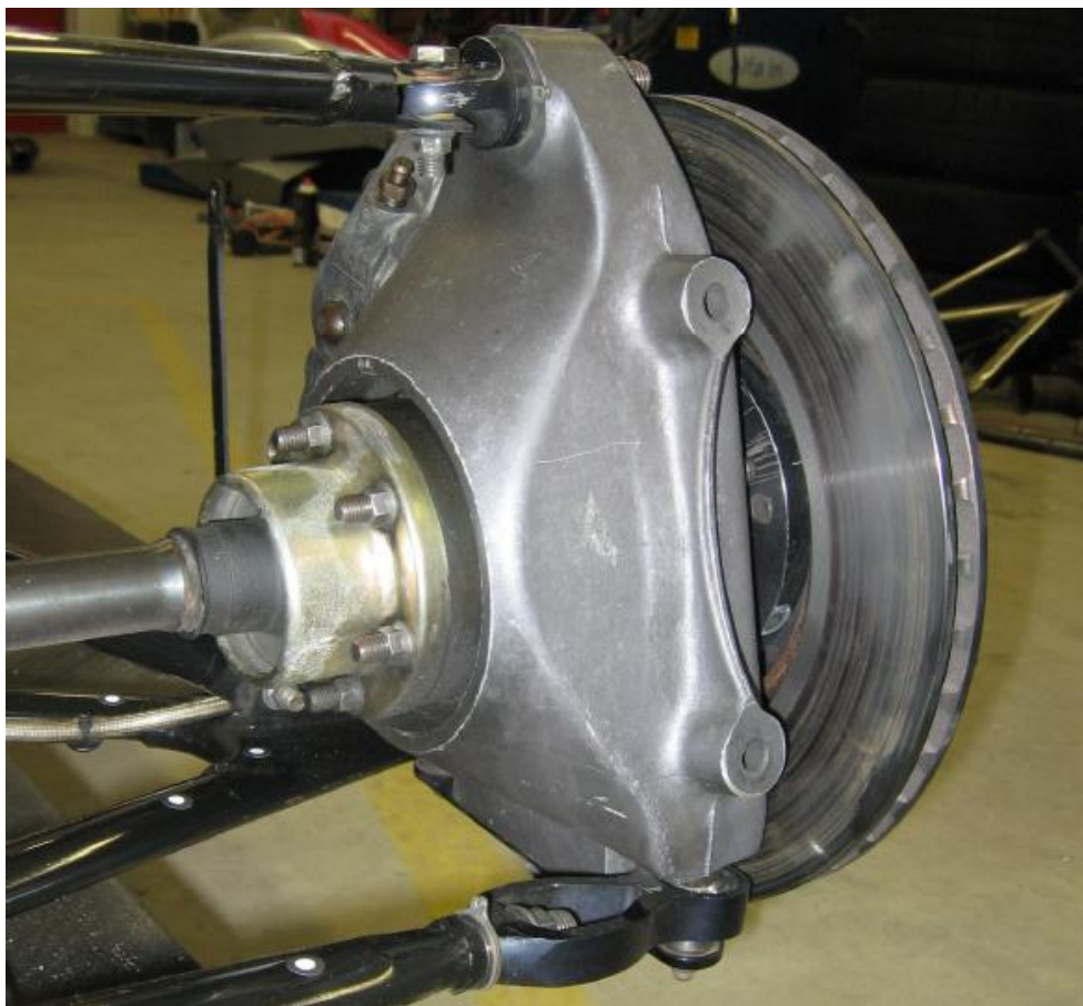
Obr. 15 Litá těhlice formule Renault [15]
