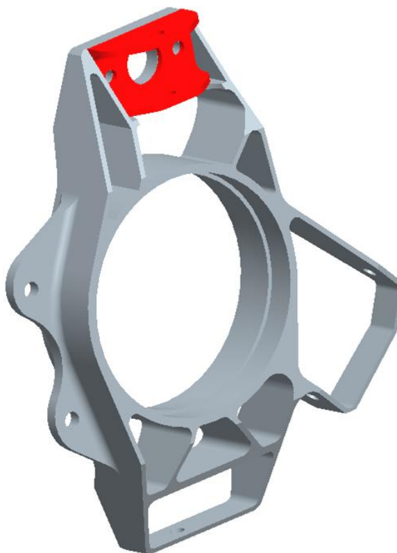
Obr. 86 Odlehčený model třetí konstrukční úpravy těhlice
