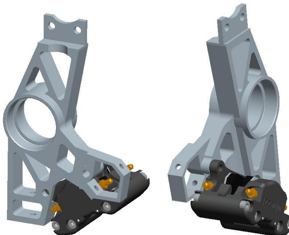
Obr. 32 Přední těhlice s brzdovým třmenem – první varianta
