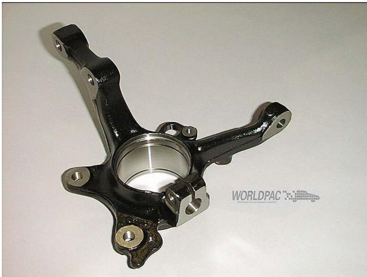
Obr. 8 Těhlice osobního automobilu [11]
