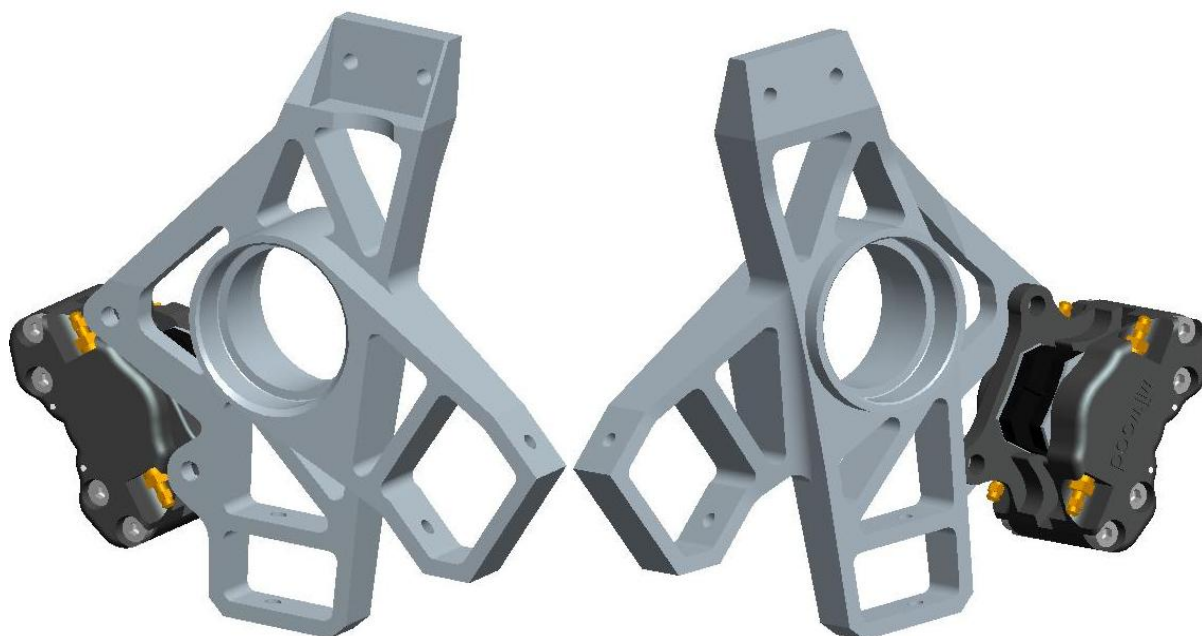
Obr. 38 Přední těhlice s brzdovým třmenem – druhá varianta
