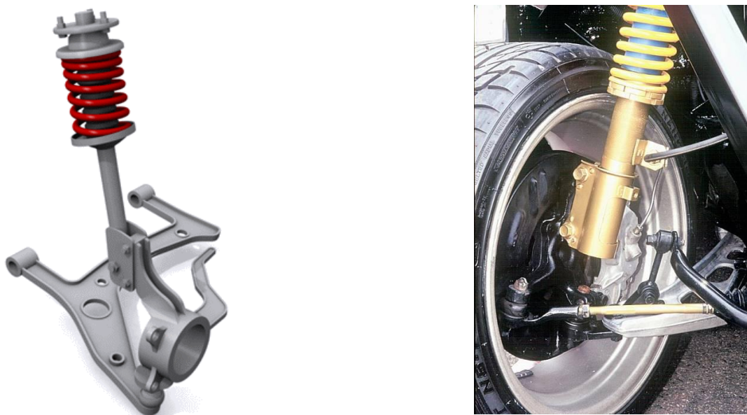
Obr. 6 Zavěšení nápravy typu McPherson [10], [14]
