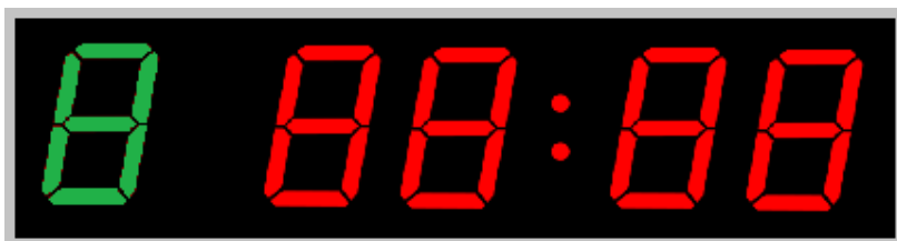
Obrázek 34: Rozmístění segmentů v displeji
