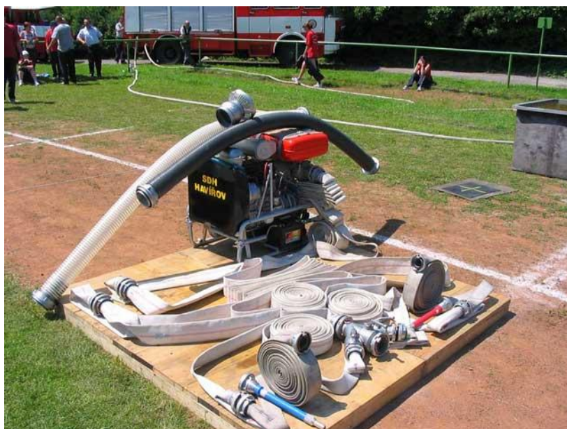
Obrázek 6: Základna a hasičská stříkačka připravená na provedení útoku [10]
