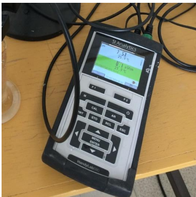
Obrázek 2.14 - Zjišťování vodivosti pomocí elektrody
