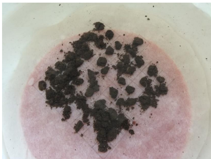
Obrázek 2.2 - Zkouška vodostálosti – detail
