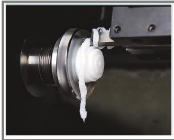
Obr. 3-23 Soustružení acetabulární vložky [43]
