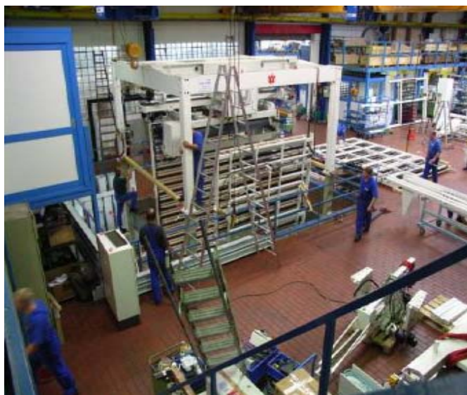
Obr. 3.10 Pokládání stroje Multinip pomocí jeřábu
