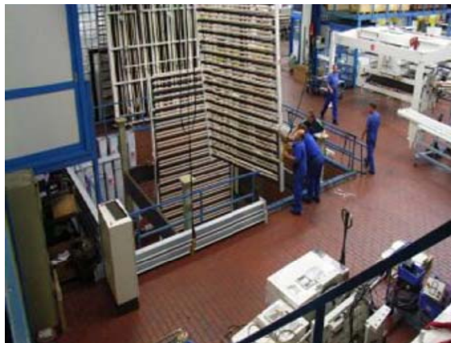
Obr. 3.9 Sestavení zadních vodících rolnic stroje do základového rámu stroje
