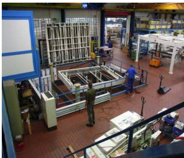
Obr. 3.7 Položení základového rámu stroje
