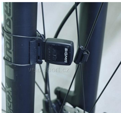
Obrázek 2 - Měřící snímač s magnetem [4]
