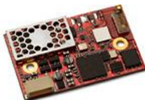
Obr. 16 Wi-Fi modul od firmy Connect Blue [11].
