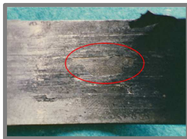
Obr. 1-16 Poškození odlupováním povrchové vrstvy [13]
