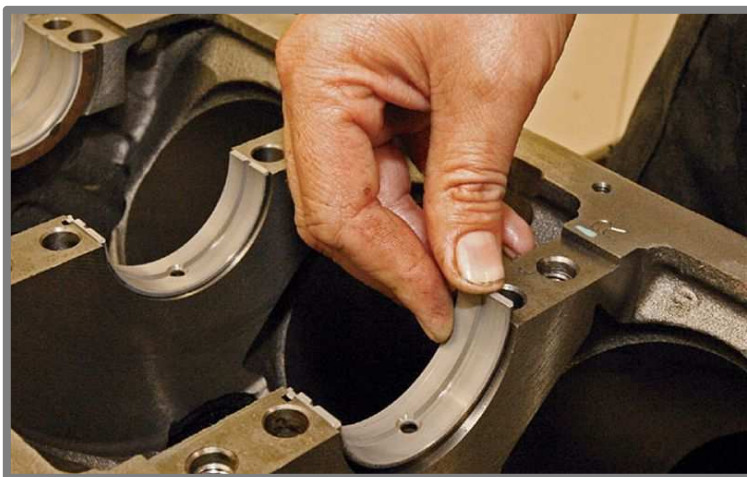
Obr. 0-1 Montáž ložiska klikové hřídele [21]
