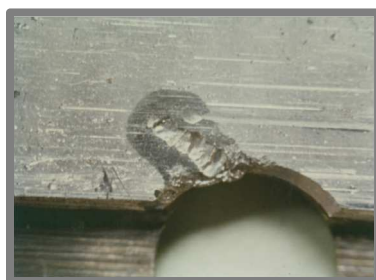
Obr. 1-12 Poškození erozí [13]
