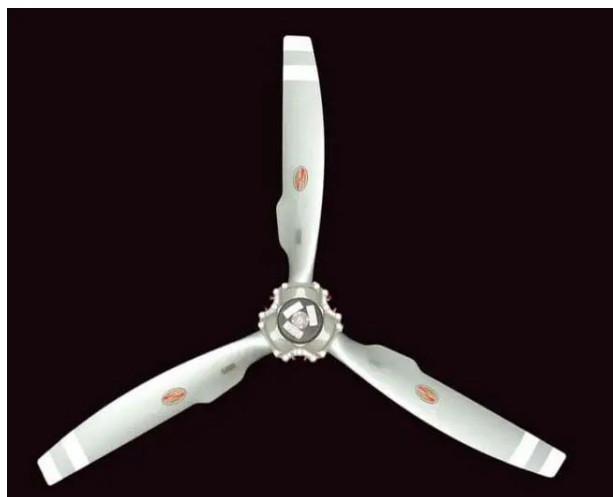
Obr. 9: Vrtule Hartzell HC-E3YR-1RF s odlišnými vrtulovými listy F7673DR-0.
