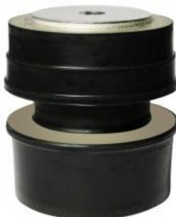
Obr. 15: Silentblok motorového lože a motoru pro letouny Piper.
