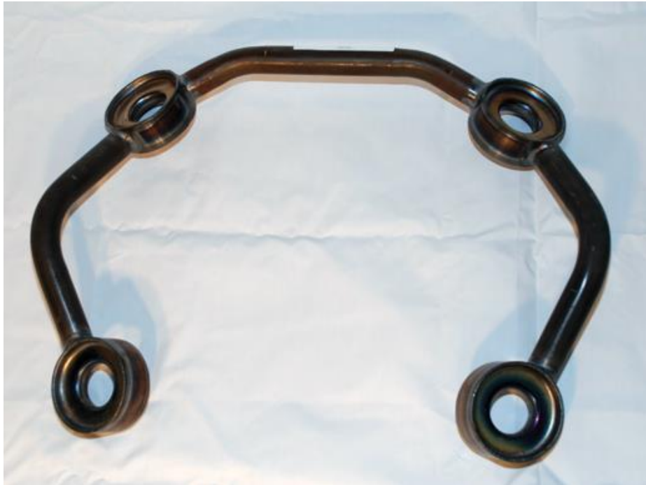
Obr. 16: Předsvařovaný dynafokální prsteneček od evropského dodavatele leteckých dílů.
