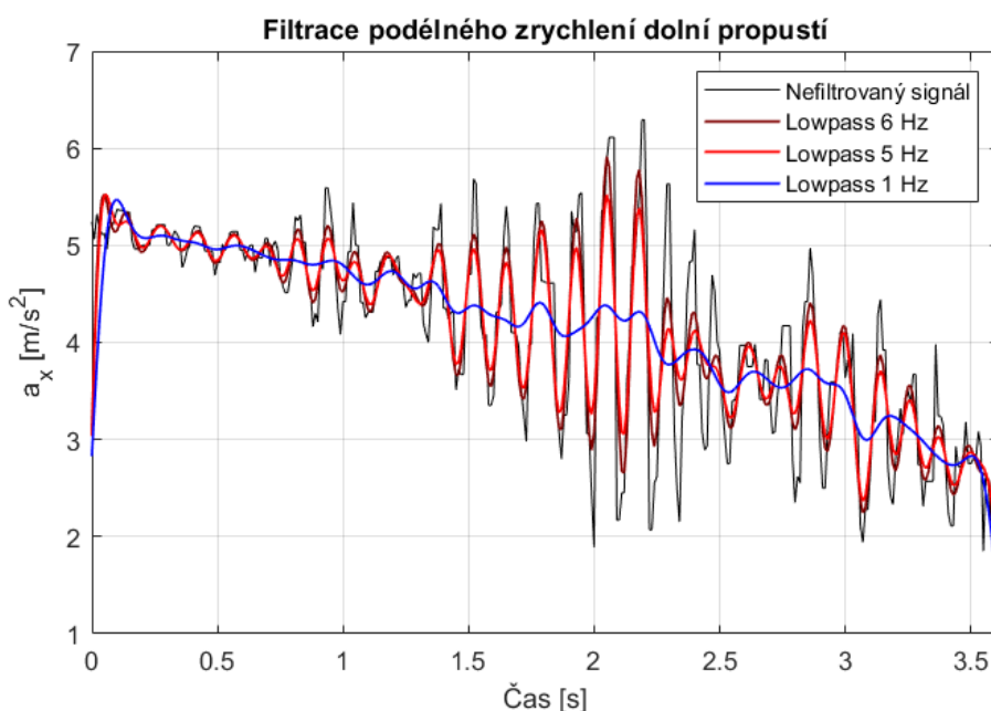
Graf 5 – Použití dolní propusti pro signál podélného zrychlení při 20 A s řidičem A
