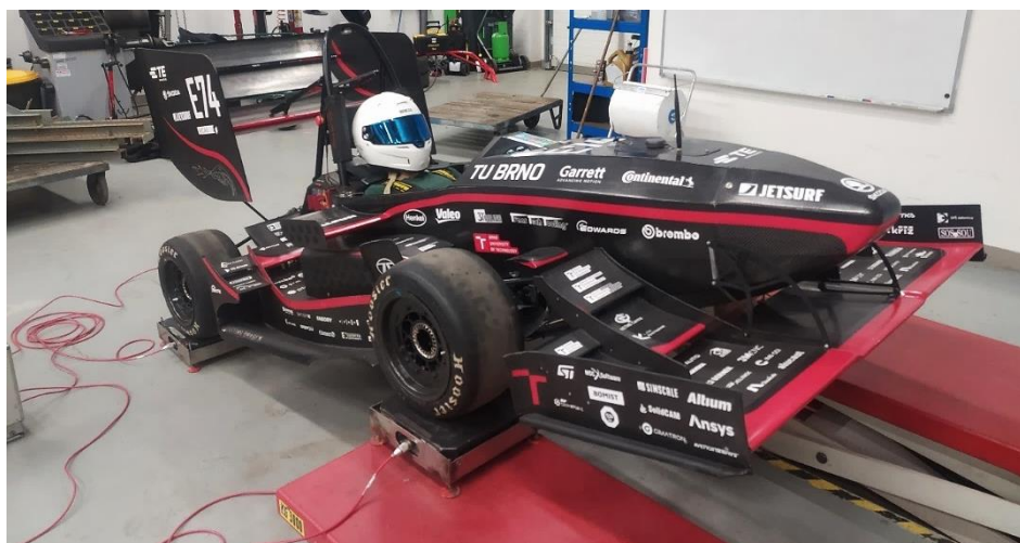
Obr. 13 – Měření těžiště vozu Dragon e2 v prostorách ÚADI [11]
