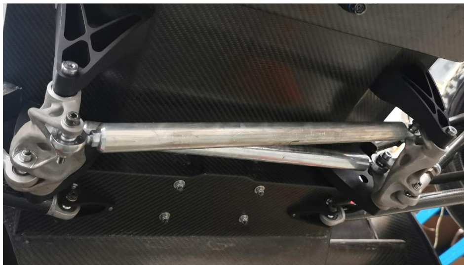
Obr. 17 – Pevné náhrady předního odpružení pro možnost přímého odečítání změny dynamického poloměru kola ze změny jízdní výšky
