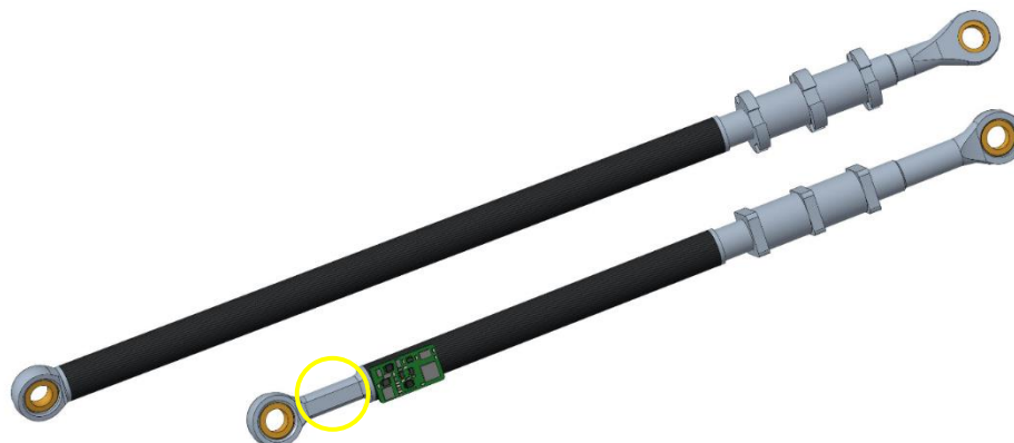
Obr. 23 – Porovnání pushrodů vozu Dragon X (nahore) a Dragon e2 (dole) s vyznačeným místem pro umístění tenzometrických snímačů
