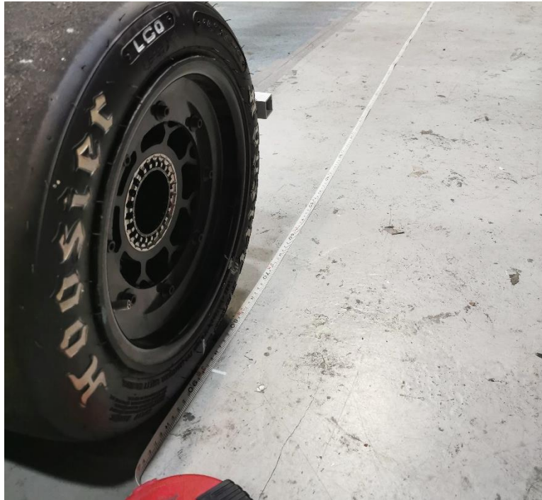
Obr. 16 – Fotografie z měření statického poloměru kola
