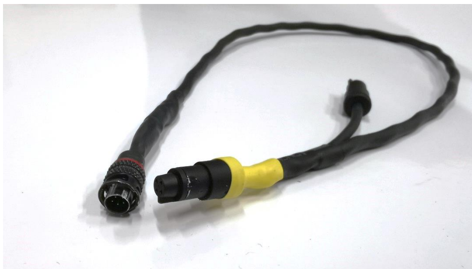
Obr. 34 – Propojení zapůjčených snímačů s integrovanou kabeláží monopostu Dragon e2
