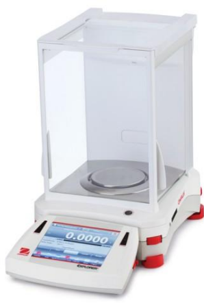
Obrázek 11 - váhy užívané k měření hustoty archimédovou metodou[18]
