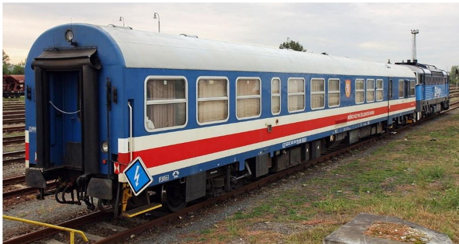
Obr. 2.20 – Měřicí vůz pro železniční svršek – fotografie [21]
