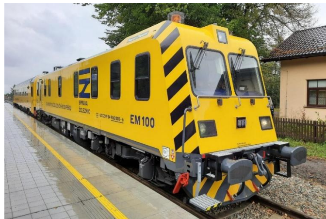
Obr. 2.17 – Měřicí drezína EM100 – fotografie [20]
