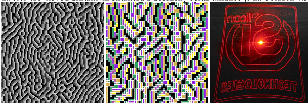
Obrázek 4.5 Difraktivní struktura, simulace expozičních dat a obraz difrakce zleva doprava
