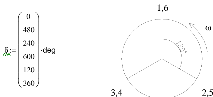
Obr. 10 Schéma pořadí vznětů jednotlivých válců motoru
