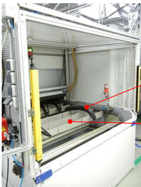
Obr.3.2 Vstup materiálu do temperační pece.
