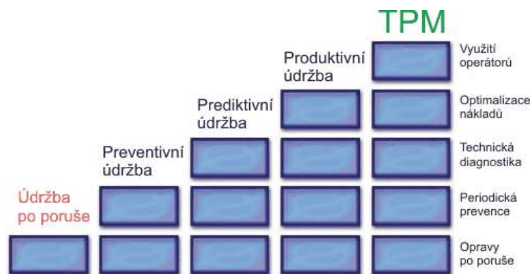
Obr. 6: Souhrnný přehled nejpoužívanějších systémů údržby (Zdroj: VOLKO, [online] 2009)
