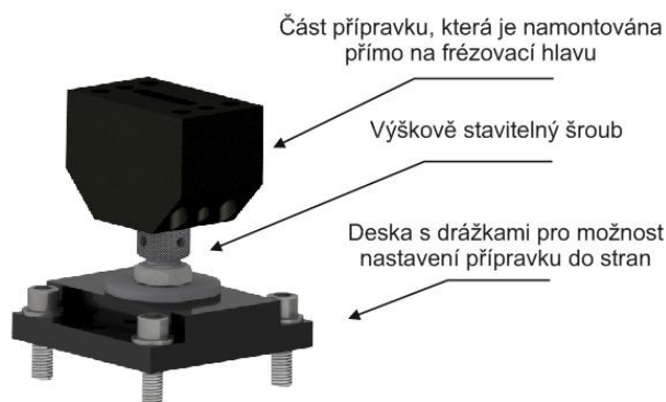
Obr.67 Přípravek pro ustavení frézovacích hlav
