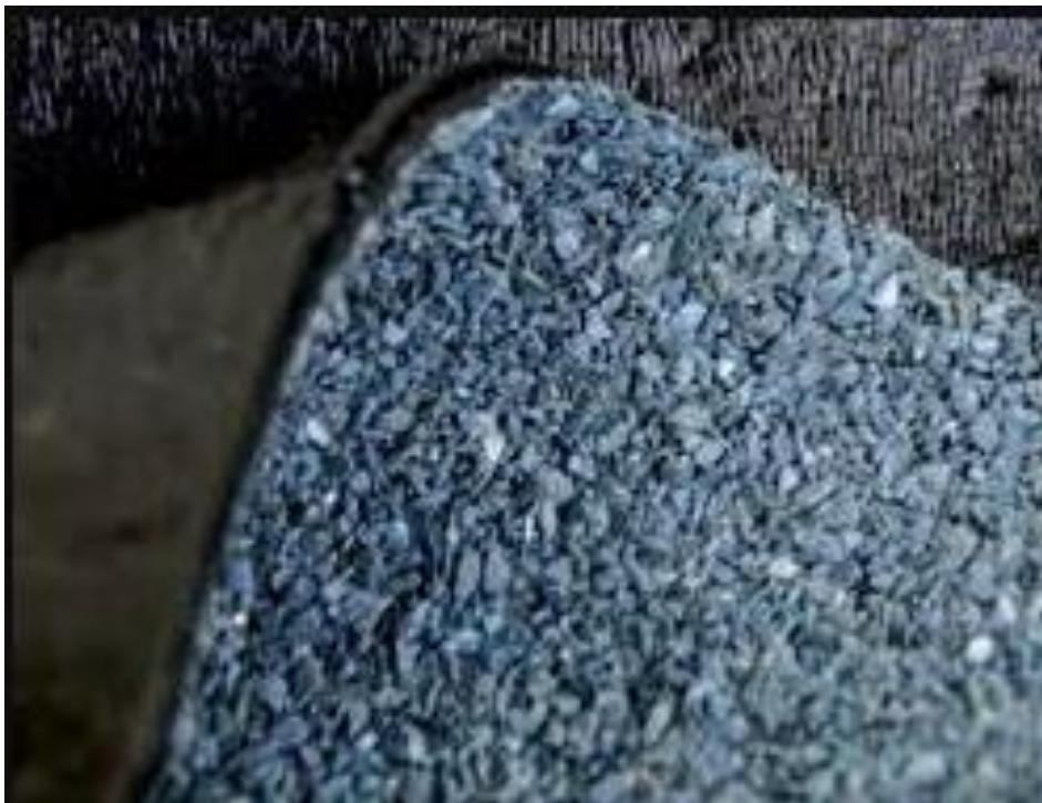
Obr. 4 - Asfaltový pás odolný proti prorůstání kořínků [6]
