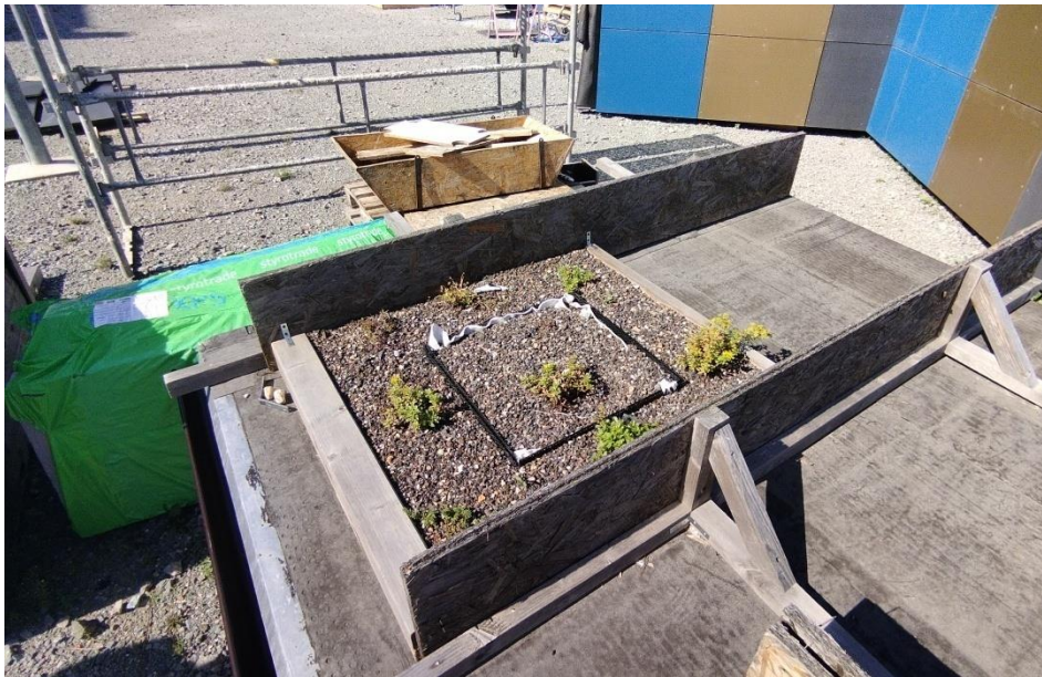
Obr. 27 - Kontrolní segment se zasazenou vegetací [zdroj: autor, 2021]
