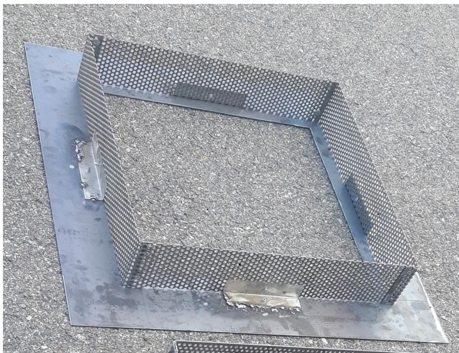
Obr. 20 - Vyrobená základna ke kontrolnímu segmentu [zdroj: autor, 2021]
