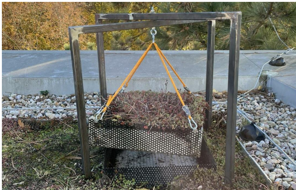
Obr. 32 - Stativ na měření kontrolních segmentů [zdroj: autor, 2023]
