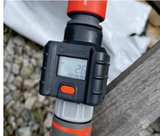
Obr. 57 - Měřidlo průtoku [zdroj: autor, 2023]
