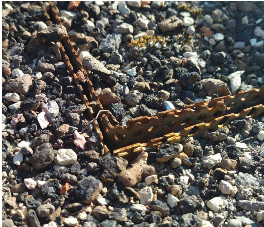
Obr. 28 - Detail kontrolního segmentu po 7 měsících ve skladbě [zdroj: autor, 2022]
