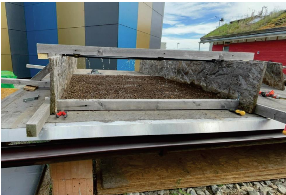
Obr. 59 - Zahájení simulace normového deště [zdroj: autor, 2023]
