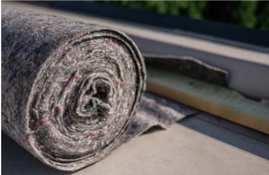
Obr. 6 - Příklad separačního geotextilie [5]
