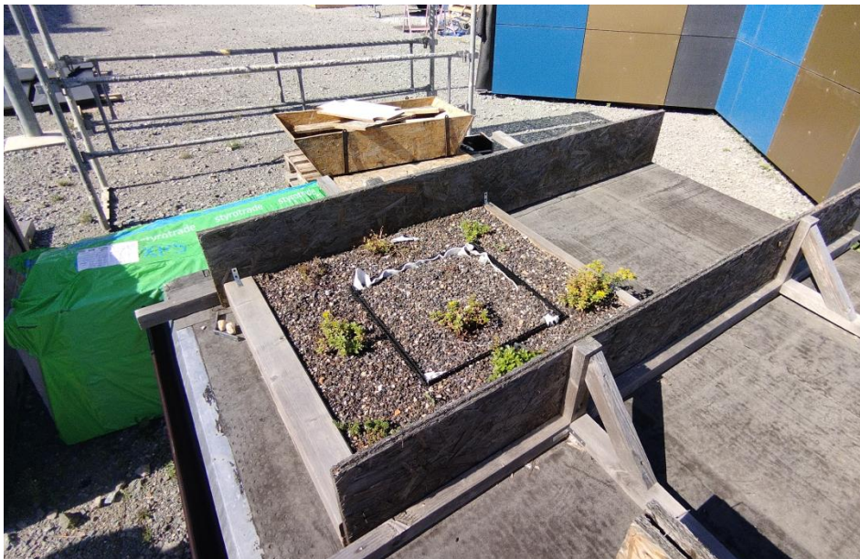
Obr. 18 - Zkušební model extenzivní zelené střechy na AdMAS [zdroj: autor, 2022]
