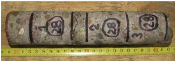
Obr. 133 Vzorek betonu Ø 50 mm sondy P(05)
