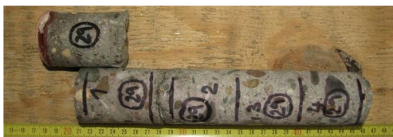
Obr. 135 Vzorek betonu Ø 50 mm sondy P(06)
