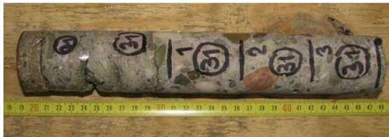
Obr. 139 Vzorek betonu Ø 50 mm sondy P(08)
