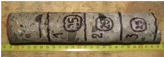
Obr. 127 Vzorek betonu Ø 50 mm sondy P(02)
