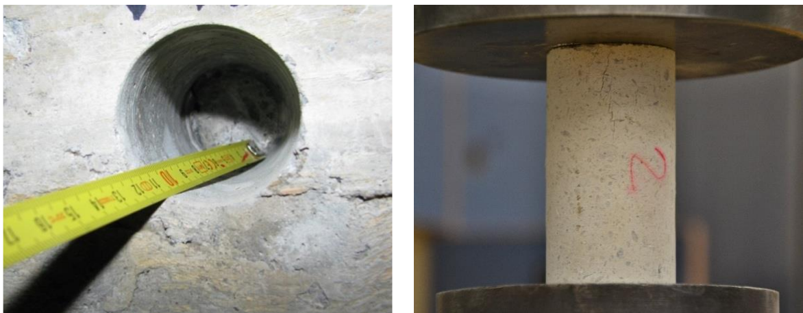
Obr. 3 Vlevo – vzniklý otvor po jádrovém vývrtu, vpravo – zkouška pevnosti v tlaku v lise [8]
