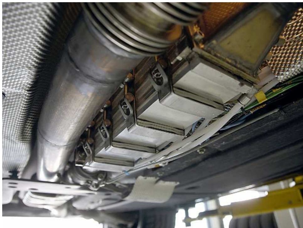
Obr. 2.4: Termoelektrické generátory zabudované do výfukového systému automobilu[10].
