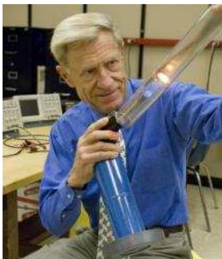
Obr.2.12: Orest Symko předvádí, jak teplo z plynového hořáku, je-li nasměrováno na přepážku v trubici, přemění se na zvuk[9].
