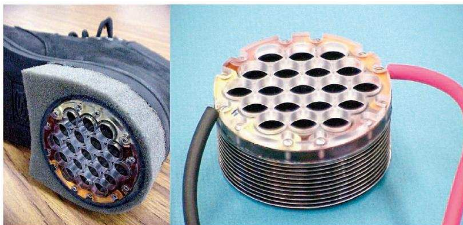
Obr.2.15: Generátor z elastomeru zabudovaný v podrážce boty[2].
