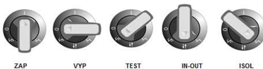
Obr. 2.2 Funkce ovládací páky [1]
