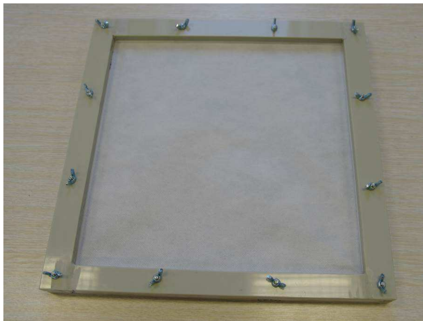
Obrázek 23 - Příklad upevnění filtru v rámečku
