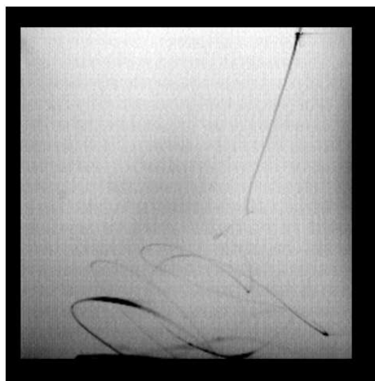
Obrázek 9 - Taylorův kužel (levá část); Bičovací fáze letu (pravá část) [16]
