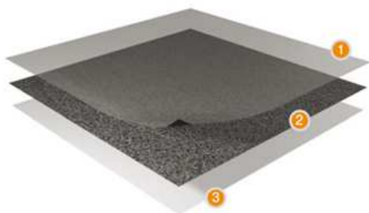
Obrázek 24 - Skladba nanovlákných filtrů
