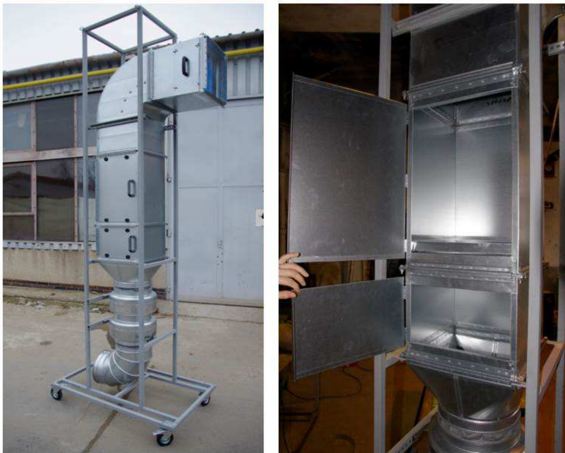
Obrázek 21 - Ventilátorová filtrační věž - realizace
