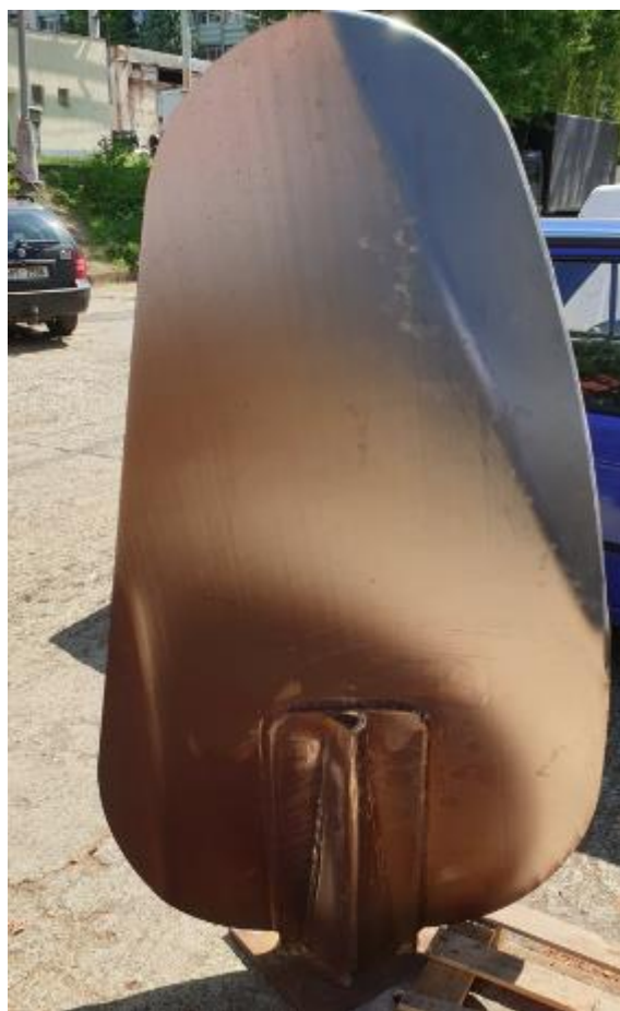
Obr. 25 Lopatka axiálního míchadla sádrovcové suspenze.
