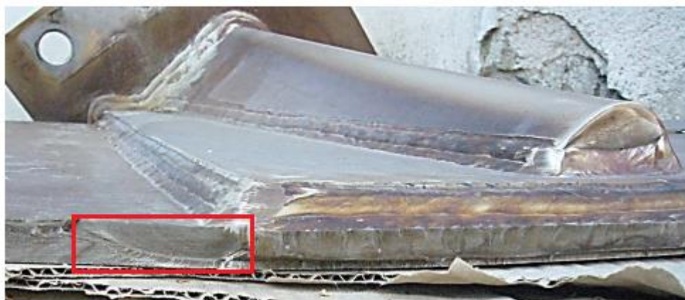
Obr. 37 Defekt lopatky vzniklý únavovým mechanismem.
