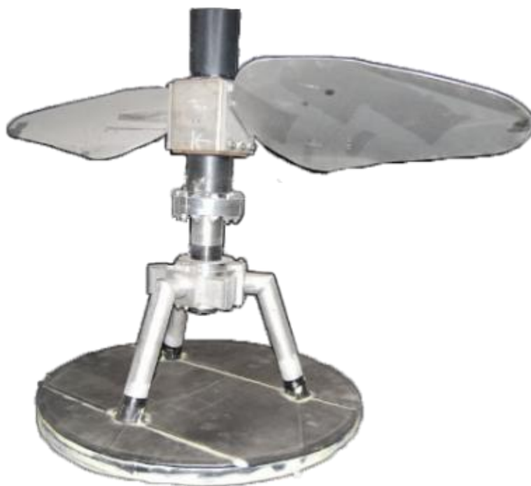
Obr. 2 Lopatky míchacího zařízení v teplárně Ledvice
