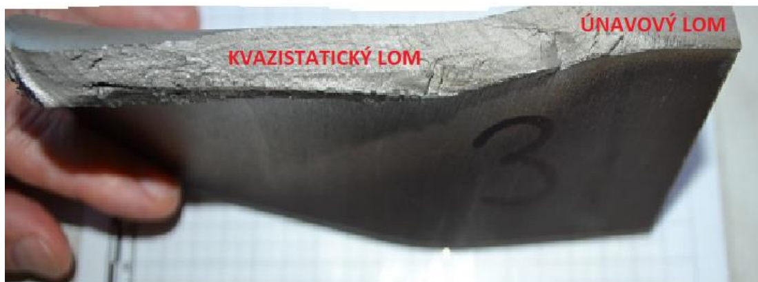
Obr. 44 Kvazistatický a únavový lom na konci lopatky (výřez 3).
