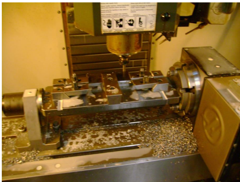
Obr. 3.3 Otočný stůl HRT210 s obdobným přípravkem.
