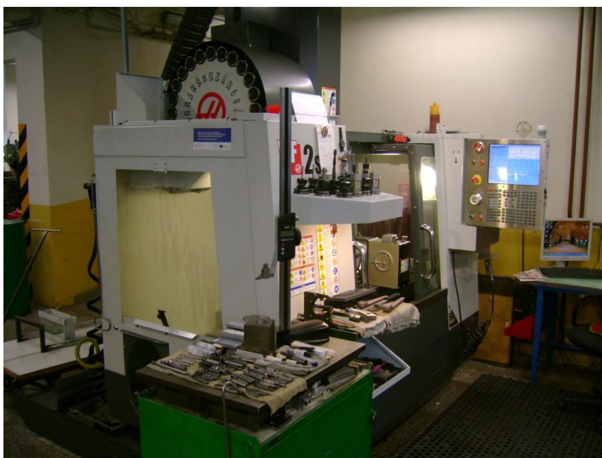
Obr. 3.2 Vertikální frézovací centrum HAAS VF-2SS.
