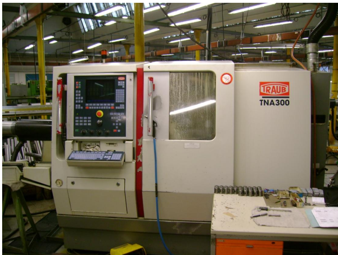
Obr. 3.1 CNC soustruh TRAUB TNA 300.
