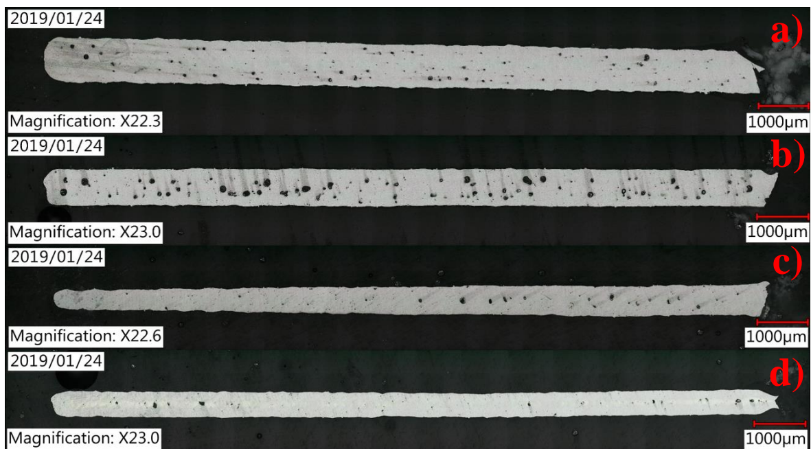
obr. B - 18 Metalografický výbrus kolmých prutů s průměry: a) 1 mm, b) 0,8 mm, c) 0,6 mm, d) 0,4 mm
