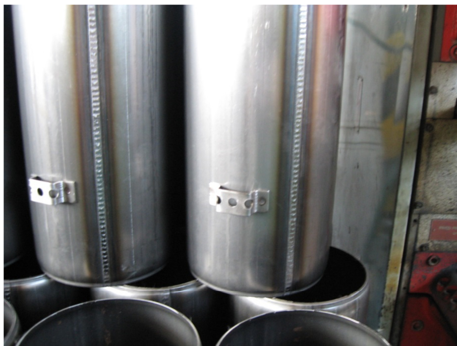
Obr. 3.4 Vnější pohled na povrch pláště hasicího přístroje, zde již s navařenými držáky na stěnu.
