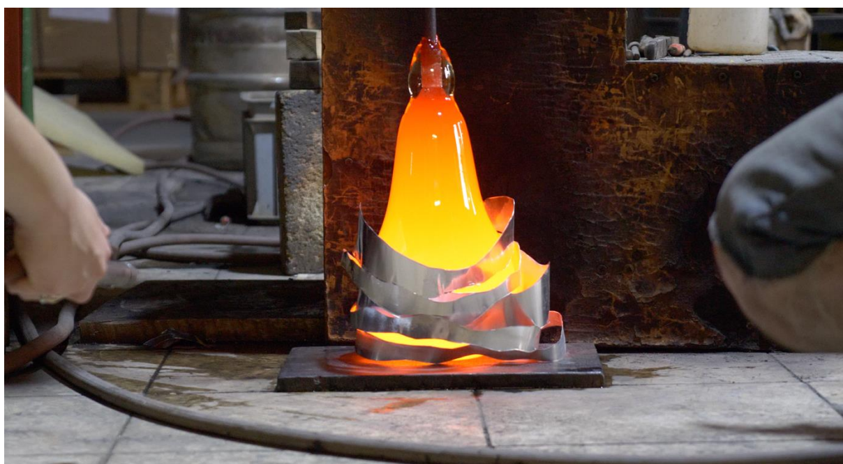
Proces foukání skleněných objektů podléhajících vrstvám prořezané hliníkové formy.
