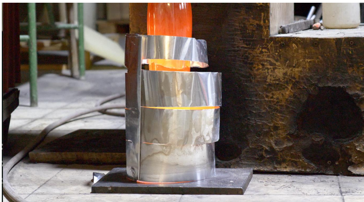
Proces foukání skleněného objektu podléhající vrstvám prořezané hliníkové formy.
