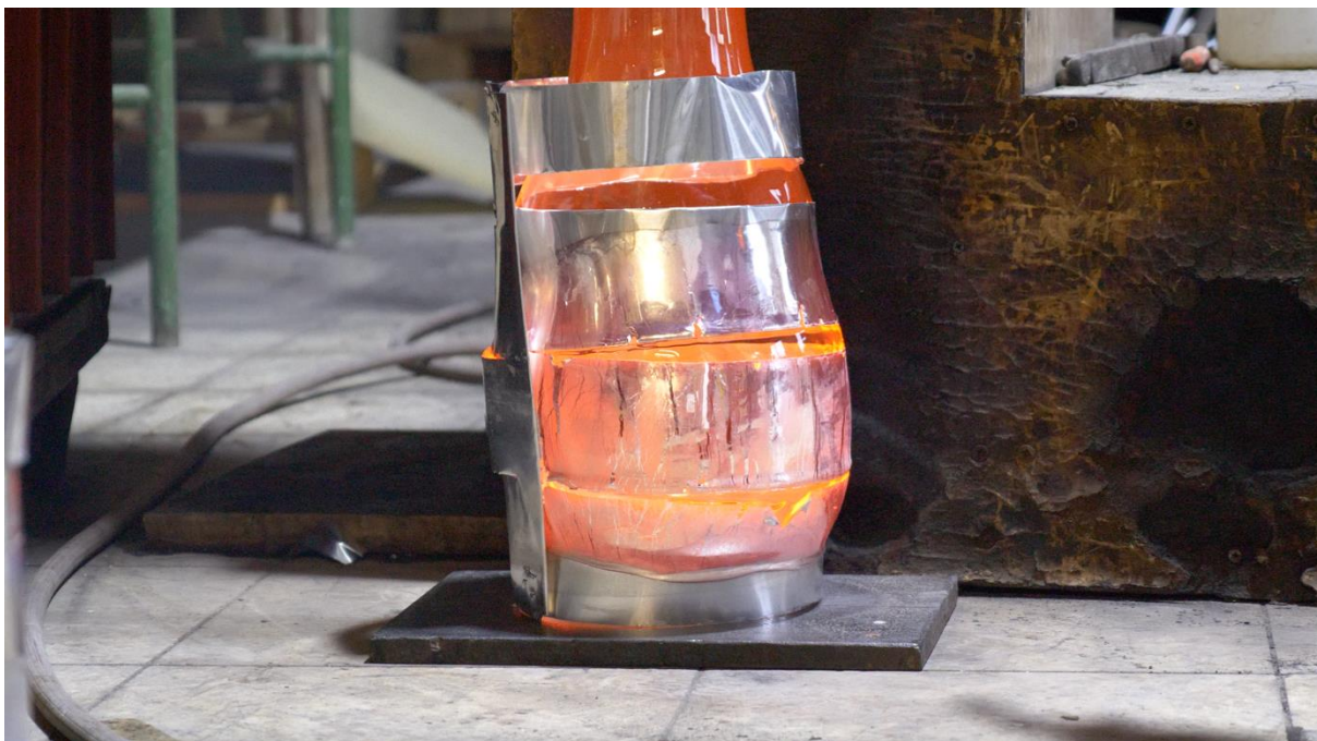
Proces pítavení prořezané hliníkové formy na sklo.
