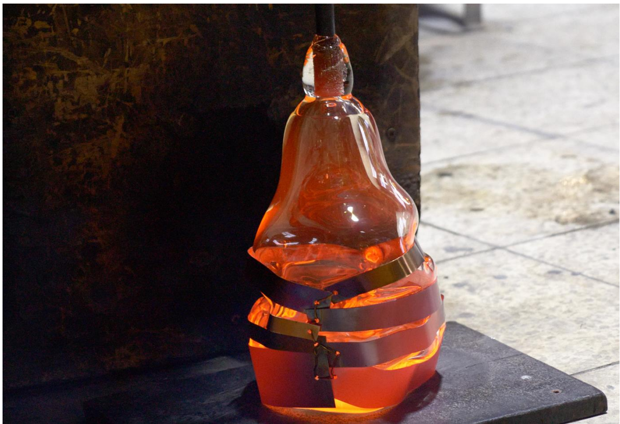
Proces foukání skla do měděné formy.
