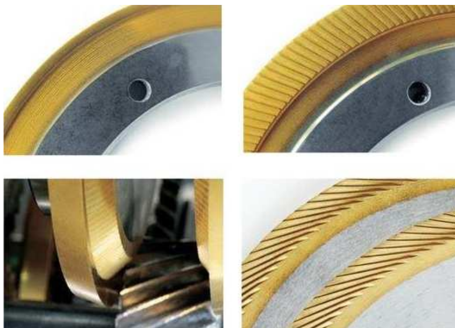
Obr. 4: Ukázka metody a nástrojů k odjehlování kol [4]
