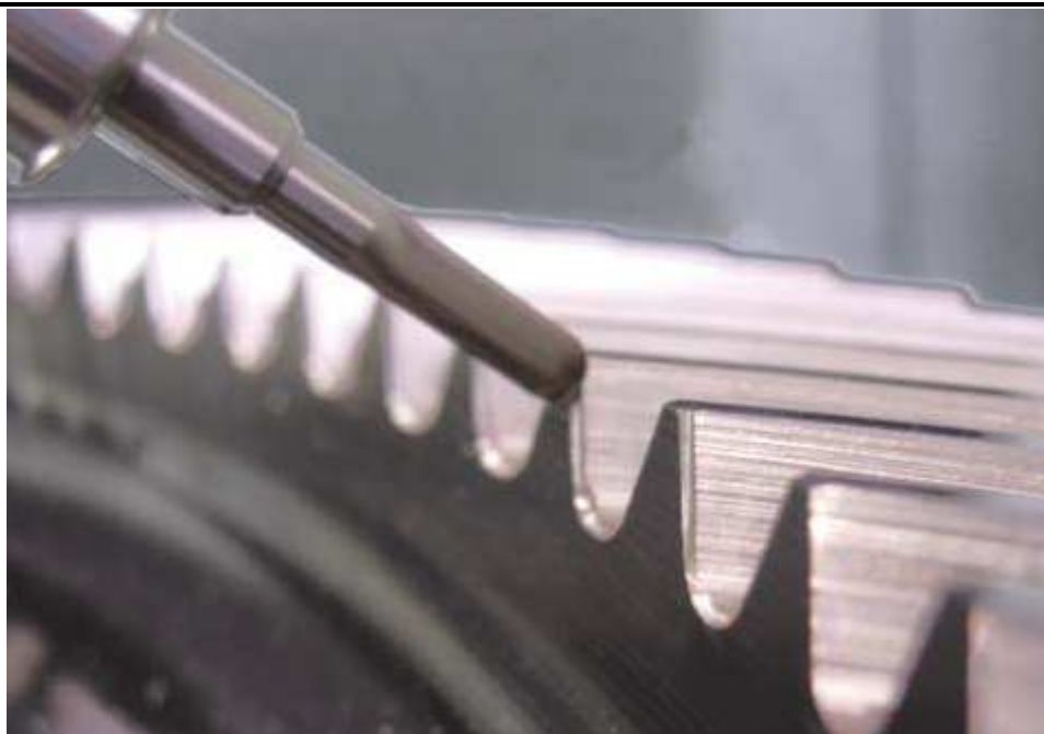
Obr. 3: Odjehlování hrany zubu frézováním na stroji KEM 502 [3]
