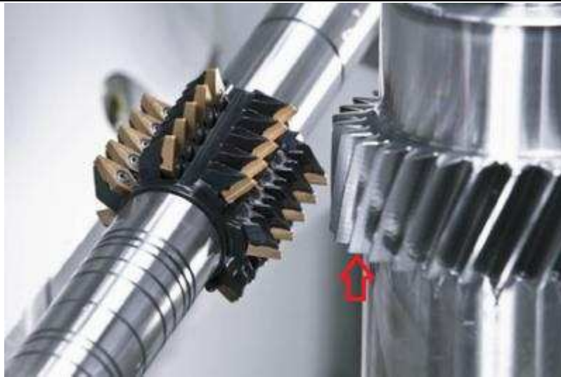
Obr. 1: Frézování odvalovacím způsobem; červenou šipkou je vyznačeno místo vzniku ostřiny [1]
