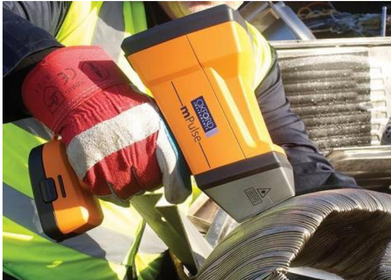
Obr. 3.2.4 – Ručný LIBS prístroj “mPulse” zisťujúci ch. zloženie a kvantitu za 1 sekundu [32]
