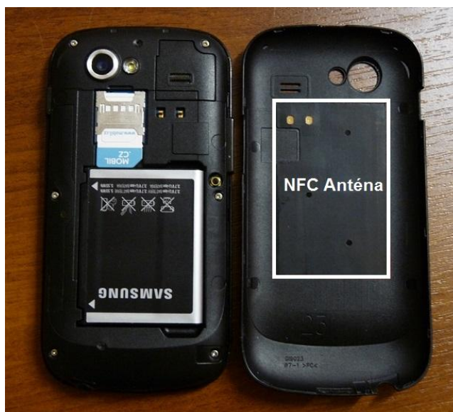
Obr. 3.1 NFC anténa na zadním krytu telefonu Samsung Nexus S
