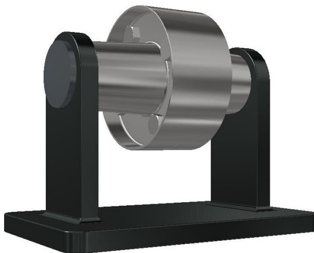
Obr. 3.11 Kotúčová spojka uložená v stojane.
