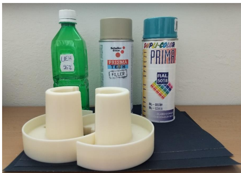
Obr. 5.6 Brúsne papiere, lieh, plnič a akrylová farba v spreji potrebné na post-processing.
