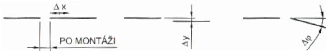
Obr. 1.5 Osový posuv a montážne nepresnosti [6].
