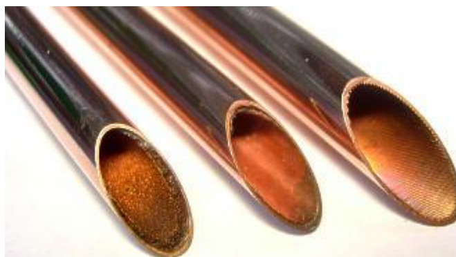
Obr. 15: Detail porézního povrchu uvnitř trubky pro „nasátí“ kondenzátu [3].
