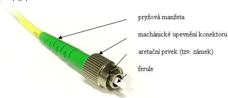
Obr. 5.11: Základní části okonektorovaného optického vlákna [31].
